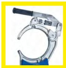
Morse adatte alla saldatura di curve e raccordi a codolo corto
