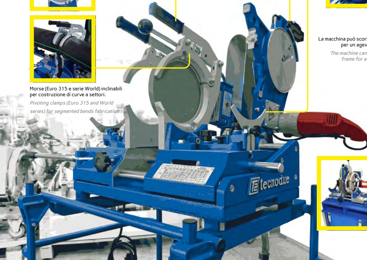
Saldatrici portatili manuali idonee alla saldatura testa-testa di tubi e raccordi in PE e PP per scarico. Macchine molto versatili e leggere, dotate di un robusto telaio concepito per un'ideale posizione di lavoro o di una comoda cassa in legno. Un pratico cassetto viene fornito per la raccolta di tutti gli accessori in dotazione. Le particolari morse sono idonee alla saldatura delle curve rasate e delle braghe in quanto dotate di un sistema innovativo di chiusura.
