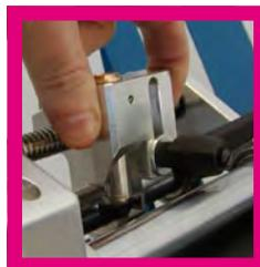
**Sistema di autocalibrazione della lama**
