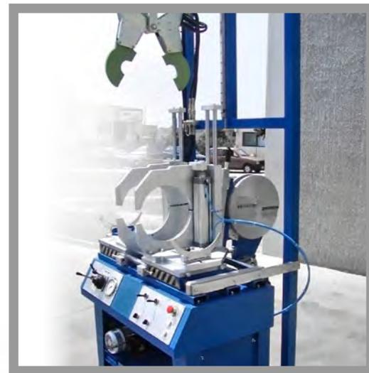
Macchine progettate per la costruzione di curve a settori di tubazioni per il teleriscaldamento (in PE con tubo interno in acciaio). Sono dotate di termopiastre apribile intercambiabile a seconda dei diametri (apertura manuale, pneumatica o idraulica a seconda della grandezza), in modo da poter saldare la guaina esterna in PE con la curva interna d'acciaio già inserita.
