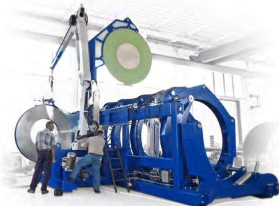
Le saldatrici serie PT "HR" sono dotate di accessori che le rendono il lavoro in cantiere più facile e comodo: le morse dotate di cilindri idraulici per l'apertura/chiusura delle ganasce superiori e cilindri idraulici per il bloccaggio/sbloccaggio del tubo. Le morse possono inoltre essere aperte e chiuse separatamente, tramite la centralina/console carrellata e dotata di maniglie per comodi spostamenti. La centralina è inoltre dotata di supporto integrato per Lettore Dati Universale.
