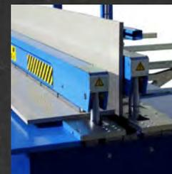
Saldatrici da laboratorio idrauliche con controllo dati computerizzato per la saldatura testa-testa di LASTRE in PE, PP, PVC, PVDF e altri materiali termoplastici.
