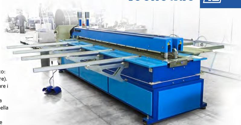
Saldatrice automatica CNC idonea alla saldatura di testa di lastre in materiale plastico: polietilene e polipropilene (da 5 a 50 mm di spessore), PVC (da 5 a 30 mm di spessore). SL 3000 Plus gestisce le fasi di saldatura in modo automatico: è sufficiente impostare i parametri delle lastre da saldare (materiale, lunghezza, spessore).
