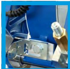
**Fermo fresatura per continuare a fresare da un solo lato**
