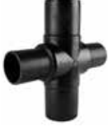
REDUCING CROSS TEE REDÜKSİYON KROS TE SDR11 PE100 GAS/GAZ : 10 BAR WATER/SU : 16 BAR TYPE/TİP : SPIGOT
