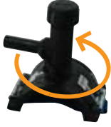
360° ROTATING OUTLET TAPPING TEE 360° DÖNER BAŞLIKLİ SERVİS TE SDR11 PE100 GAS / GAZ : 10 BAR WATER / SU : 16 BAR
