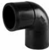
ELBOW (90°) / DİRSEK (90°) SDR17 PE100 GAS/GAZ : 6 BAR WATER/SU : 10 BAR TYPE/TİP : SPIGOT
