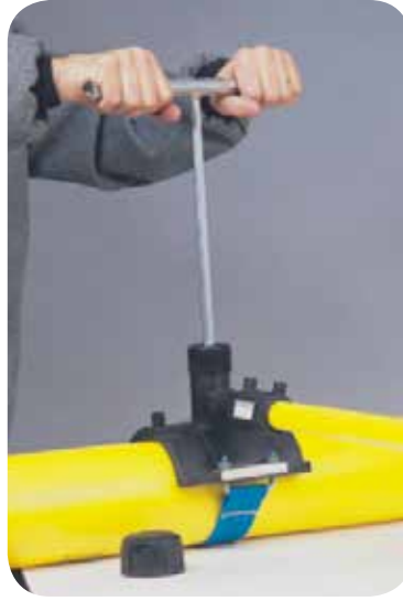
Branşmanın delinmesi/ Tapping process
