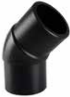
ELBOW (45°) / DİRSEK (45°) SDR11 PE100 GAS/GAZ : 10 BAR WATER/SU : 16 BAR TYPE/TİP : SPIGOT
