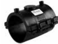
EF REPAIR SADDLE EF TAMİR SEMERİ SDR11 PE100 GAS / GAZ : 10 BAR WATER / SU : 16 BAR
